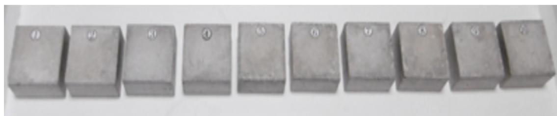
**考察** | モルタルは水に濡れることによってアルカリを発現し、これが空気中の二酸化炭素と反応することで白華現象が起り、美観を大きく損なってしまいます。この様なトラブルの改善策として弊社および他社製品のコート剤をモルタルに塗布し、灰汁に似せたアルカリ液を使用したエフロレッセンスの発生防止に効果があるかどうか確認を行いました。その結果、②OXC-FD(366)、③OXC-FD(344)、④OXC-341、⑤OXC-FD(366)+US-8、および⑩OXC-W102がその効果がある事が確認されました。
